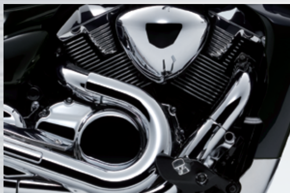
水冷V型雙缸DOHC引擎
