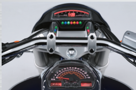
多功能雙層LCD儀表板 (時間、檔位、里程、油量、轉速)
