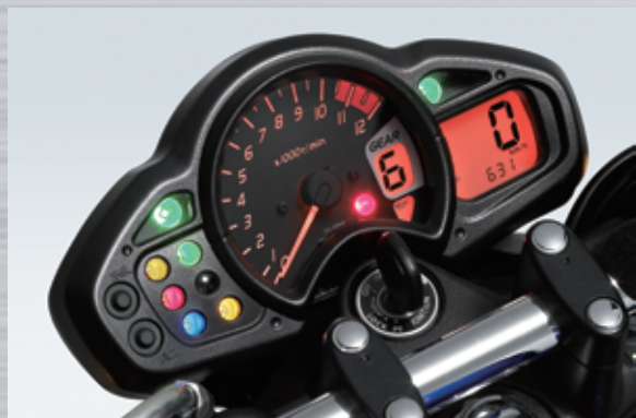
多功能LCD儀表板(時間、檔位、時速、里程)
